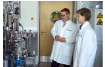
Im Gespräch mit PD Dr. Yvonne Genzel, Fachgebiet Bioprocess Engineering, Max-Planck-Institut für Dynamik komplexer technischer Systeme, am Bioreaktor zur Virusproduktion für mögliche Impfstoffe
